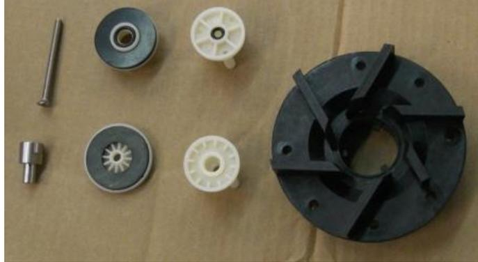
**Valve Parts Disassembled**
